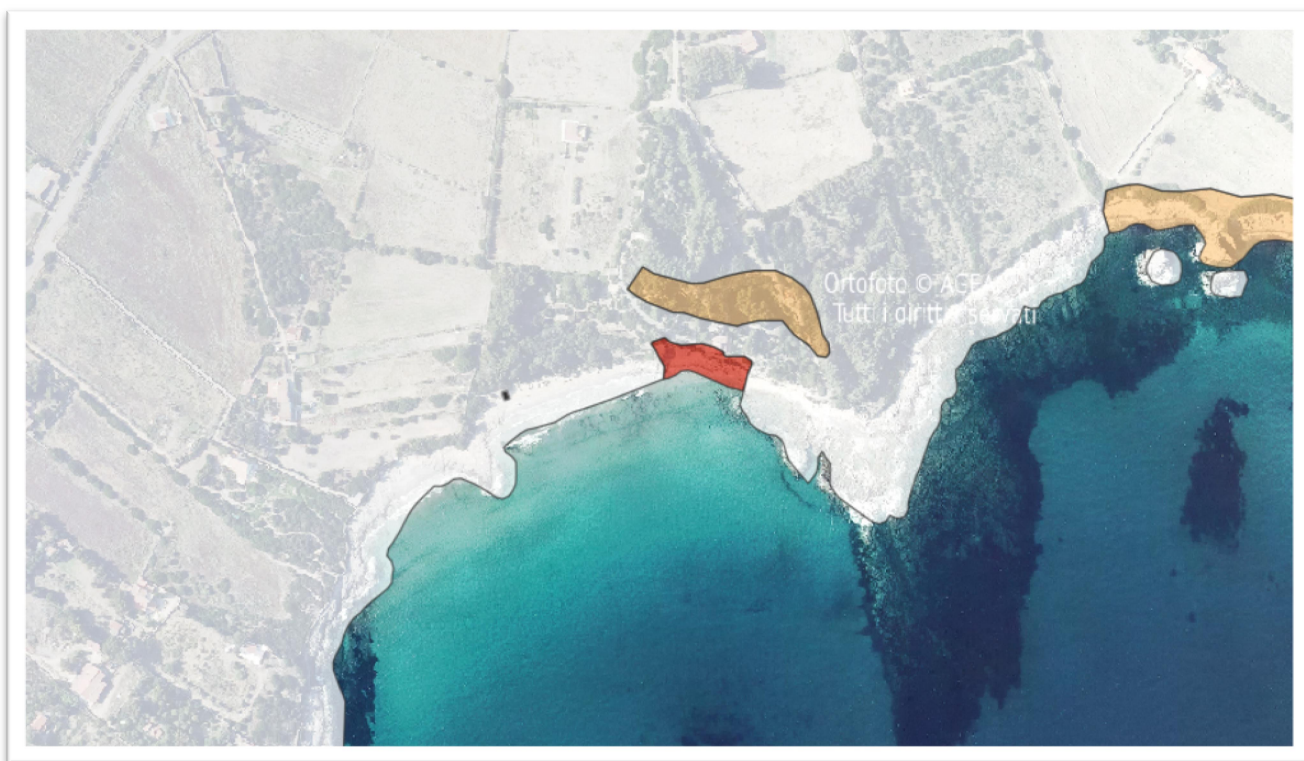
Guidi – mappatura della pericolosità da frana H_g su Ortofoto 2019
